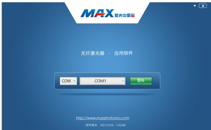
(6) 使用随机自带的串口连接线连接激光器和 PC 机，选择端口号，登陆激光器，进入如下监控界面。备注：在进入监控界面，系统默认选择外控模式。外部调制 / 使能 / DA 信号控制。
