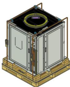
移除拉紧带及 PE 袋，注意拉紧带棘轮的操作方向和拉紧带打开方法：
