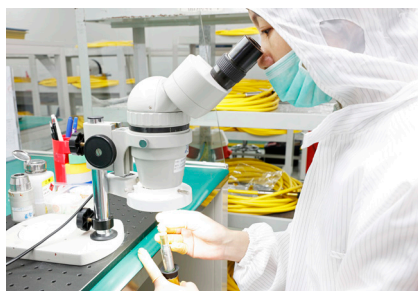
显微镜上安装光纤连接器
