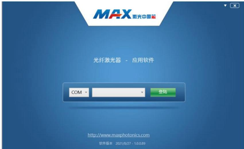
(6) 使用随机自带的串口连接线连接激光器和 PC 机，选择端口号，登陆激光器，进入如下监控界面。备注：在进入监控界面，系统默认选择外控模式。外部控制 / 使能 /DA 信号控制。
