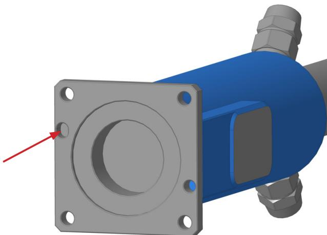
3、以定位销为基准，将 LOE 对接到切割头上，使用配套螺丝固定即可。
