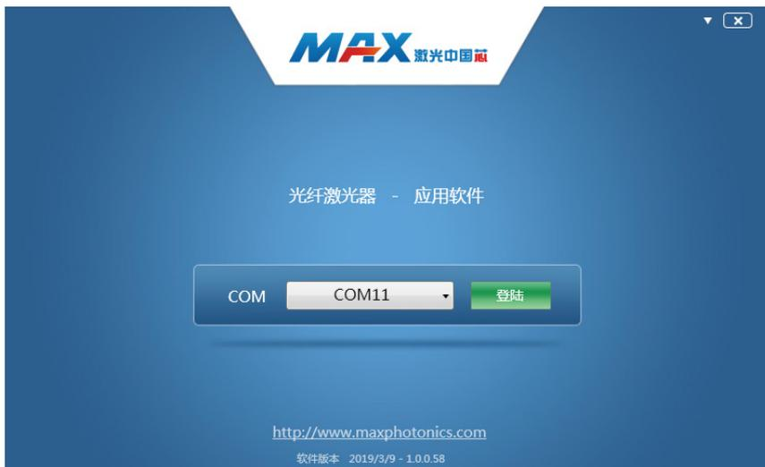
(5) 使用随机自带的串口连接线连接激光器和 PC 机，选择端口号，点击连接激光器，进入如下监控界面。备注：在进入监控界面，系统默认选择外控模式。外部调制 / 使能 / DA 信号控制。
