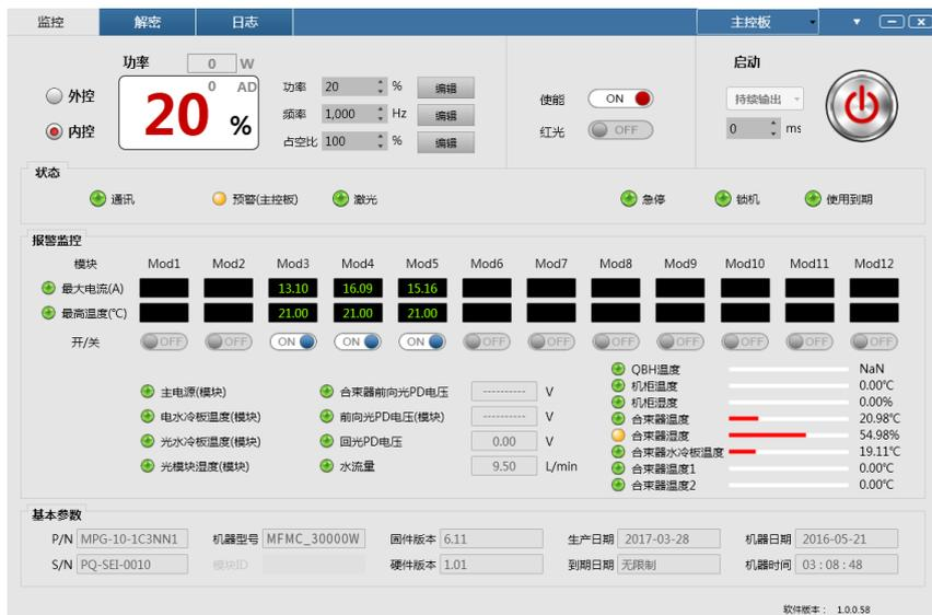
(12) 内控出激光状态下点击启动按钮关闭激光。
