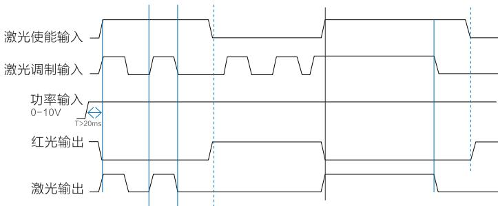
时序具体说明：功率模拟量 0-10V 信号至少提前 20mS 提供给激光器，调制及使能高电平信号输入，红光关停，激光输出。使能高电平信号降低，红光输出，激光关停。
