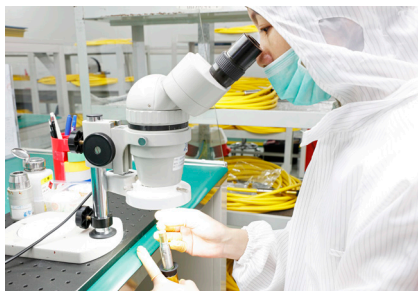
显微镜上安装光纤连接器
