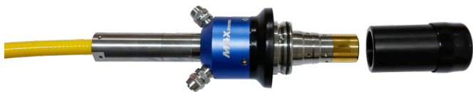
取下光纤保护套筒和内保护盖
