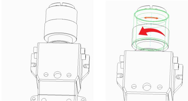
2、将清洁完成的 LOE 公头插入对应母头固定槽位位置，为避免 LOE 端面及切割头内部受到灰尘污染，请确保在 LOE 及切割头处于水平状态下进行安装；
