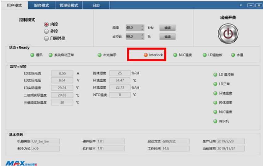
Interlock 报警说明激光器外控接口通讯异常，请检查外控线的连接是否正常。
