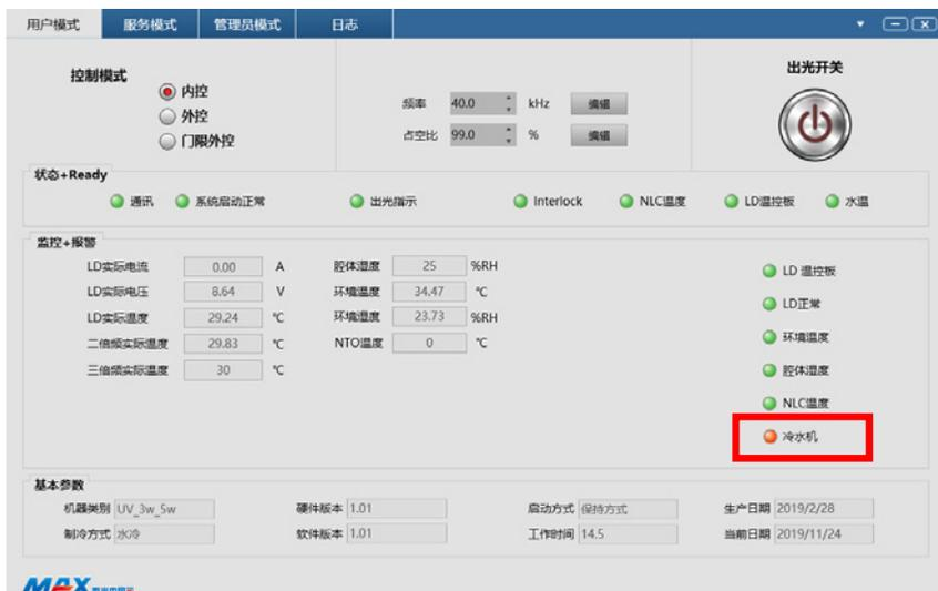
冷水机报警说明冷水机与激光器的通信状态有所异常，可能是冷水机尚未启动引起的，也可能是水冷机报警线未连接造成的；当出现冷水机报警时，请检查冷水机的工作状态及冷水机与激光器的连接状态。
