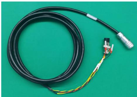
四芯航插母头的水机报警线接冷水机的常闭开关两端；剩余的两根 INTLK 接头接客户的集成设备，常闭信号有效。
