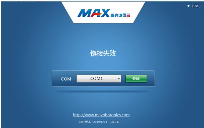
(2) 连接不正常情况下点击确定，登录后会显示如图界面，下方绿色进度条表示激光器启动中，请等待；为了方便操作建议先给激光器上电，再双击软件图标，这样软件能够自行搜索 COM 口，然后出现如下界面：
