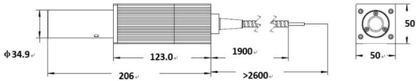
激光器外观尺寸如下图所示（单位：mm）
