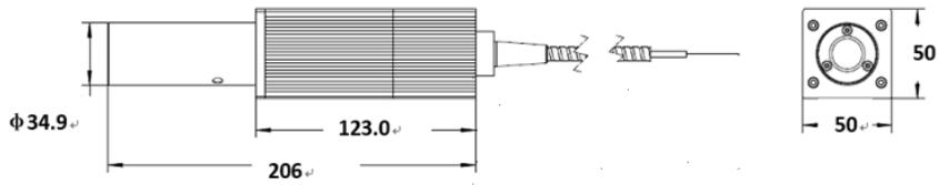
激光器外观尺寸如下图所示（单位：mm）
