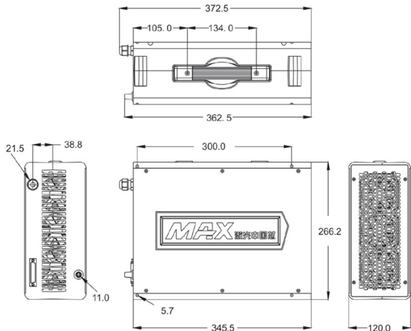
激光隔离器输出头尺寸如下图所示（单位：mm）
