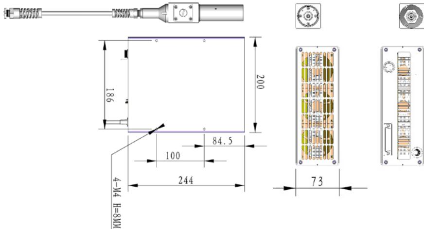
30X/50X 激光器外观尺寸图（单位：mm）
